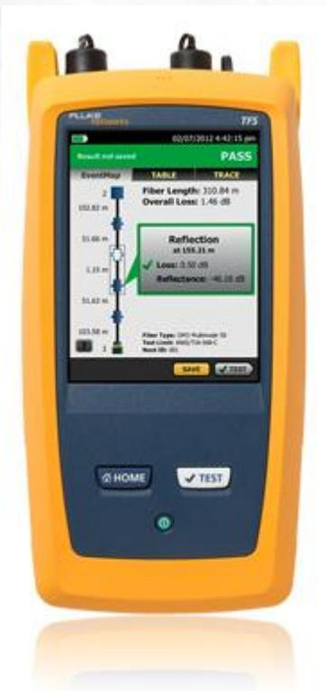
Versiv: 使用 OptiFiber Pro 完成 高解析度OTDR 测试
